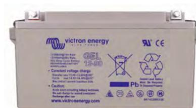
Debido al uso de materiales de gran pureza y de rejillas de plomo-calcio, las **baterías AGM y GEL** tienen una autodescarga muy baja, lo que permite largos periodos de almacenamiento sin necesidad de carga. Ambas gamas tienen terminales de cobre plano con pernos M8, lo que elimina la necesidad de bornes de batería. Cumplen con las normativas CE y UL y sus recipientes son de ABS resistente al fuego. Disponen de la garantía de Victron Energy de dos años con cobertura mundial.
