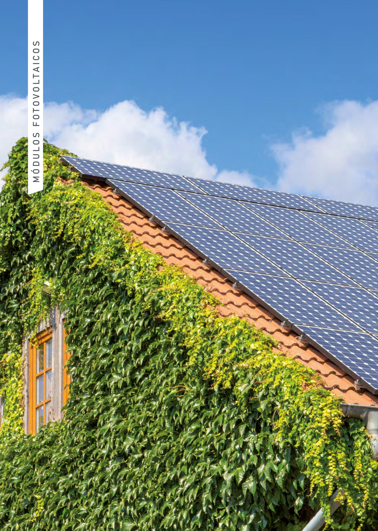
El **panel fotovoltaico** es un dispositivo formado por un grupo de células fotovoltaicas, conectadas mayoritariamente en serie, que transforman la luz directamente en electricidad de corriente continua.
