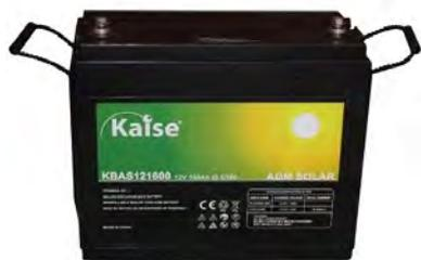
Las **baterías monoblock AGM Kaise Solar** son baterías estancas que disponen de una configuración de rejilla única con mayor distancia entre placas y baja densidad de electrolito, que junto con el separador AGM de alta calidad ralentiza la corrosión de la rejilla de placa y asegura una larga vida útil en funcionamiento estacionario. Cuentan con una vida útil de hasta 400 ciclos a 60% de profundidad de descarga (C10) con perfil de carga IU a 20°C
