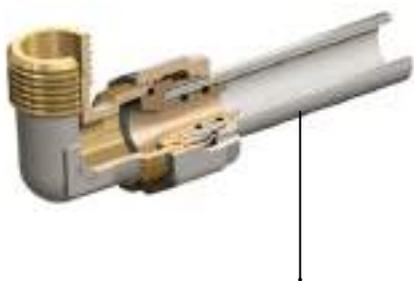
El uso de los racores de apriete hace que la instalación sea rápida y sencilla y sobre todo, que se puedan realizar con un equipamiento mínimo. Todos los racores están dotados de su correspondiente anillo de PTFE que aísla eléctricamente el aluminio del racor de latón.
