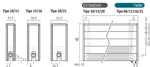
**Conexión a pared bitubo a derecha o izquierda**
