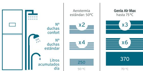
185 litros de acumulación integrada, 10 °C agua de red, 40 °C temperatura de uso
