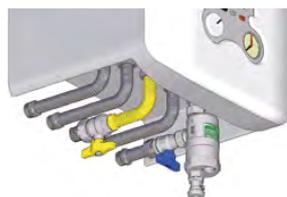
Ejemplo de instalación en el retorno con válvula de cierre de bola.
