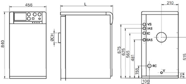
VS: Válvula de seguridad 1/2"
