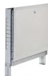
Se suministra con cerradura de ranura, pies regulables en altura de 0 a 100 mm y protección contra yesos y cascotes. Puerta a la cara del enlucido espesor 3 mm.
