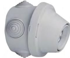
Aplicue 100W - 4A - 250V - Base Plexo - IP 20 - Clase II - Con caja redonda Ø70 mm, con 4 conos de entrada directa para montaje en posición recta o inclinada según la orientación de la tapa - Casquillo E27 - Portalámparas de porcelana - Gris - Conexión mediante borna con tornillos.
