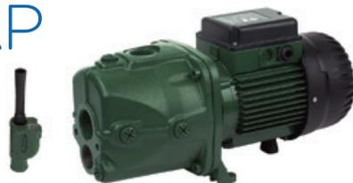
Bomba centrífuga autoaspirante para aspiración profunda hasta 27 metros, por mediación de un inyector. Idónea para pozos de 4 o mayores.
