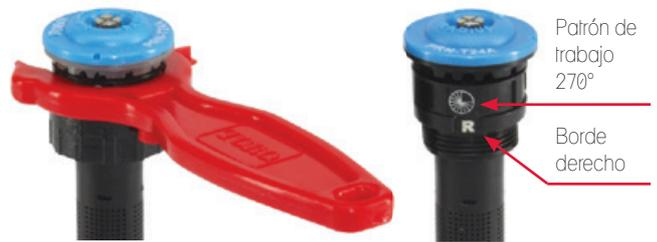
El exclusivo método de ajuste permite preestablecer el arco a mano o con la herramienta antes de instalar la boquilla. Unos indicadores visuales permiten al usuario ajustar rápidamente el arco deseado entre 45° y 270°. La banda de ajuste puede modificarse a mano o con la herramienta incluida.
