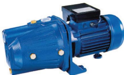
Electrobomba autoaspirante ideal para pequeños riegos y grupos de presión. Autoaspirantes hasta 9 m. Cuerpo de fundición, turbina en latón y cable Schuko-M.
